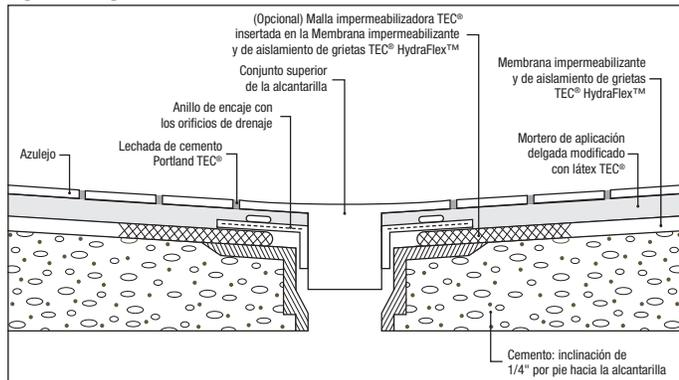
**Nota:** Este diagrama muestra el detalle de una alcantarilla típica y no está diseñado para realizar recomendaciones de diseño específicas.
